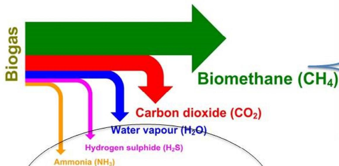
**Pre-trattamenti:** unità di rimozione di H<sub>2</sub>O, H<sub>2</sub>S, NH<sub>3</sub> e Altri componenti prima dell'unità BUS
