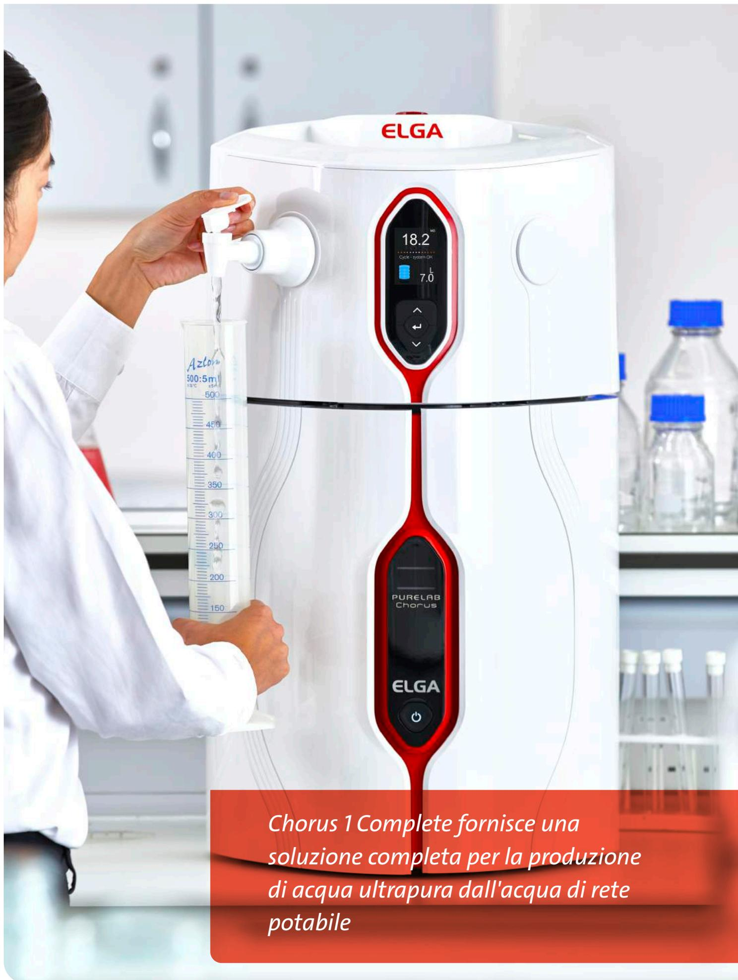
*Chorus 1 Complete fornisce una soluzione completa per la produzione di acqua ultrapura dall'acqua di rete potabile*
